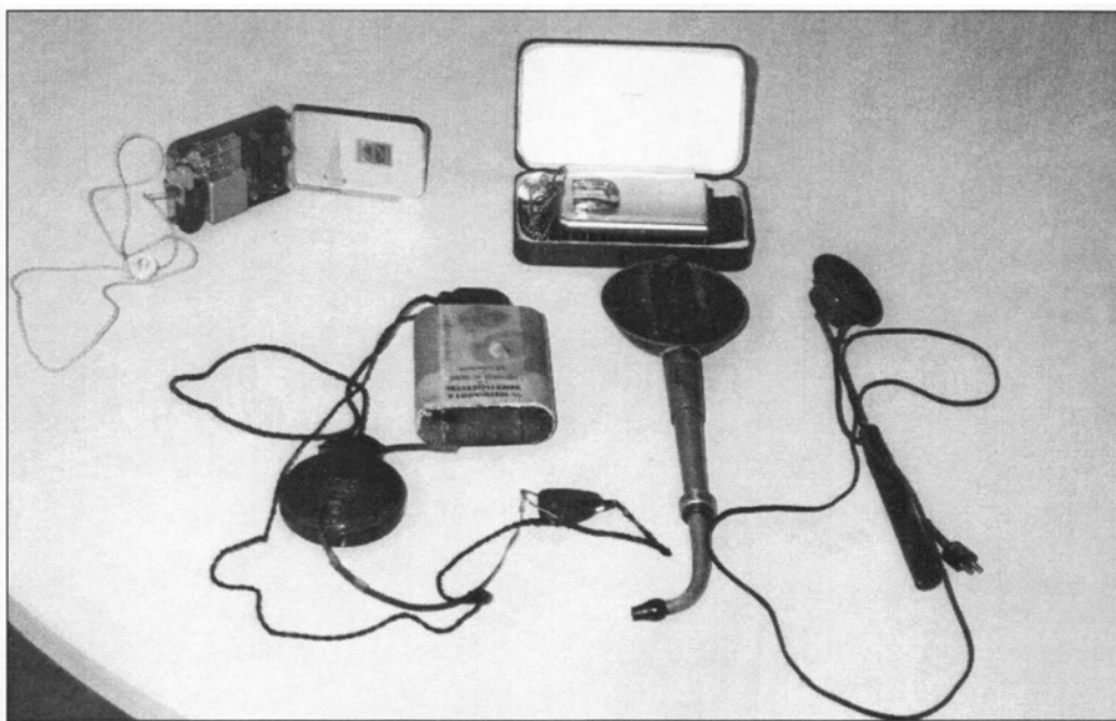
Den som på 1930- och 1940-talen hade råd förvarade sin hörapparat i ett etui med batteriet i en skild dosa. Nere t.v. en "varmansapparat"; batteriets vikt ca 112 kg. I mitten en hör-tallur av mässing från 1800-talet. T.h. en hörstav till en seriehörapparat.
